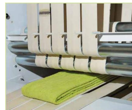
La prima piega è effettuata tramite flusso d'aria pulsato. Prima che il capo abbia ricevuto la prima piega, ne viene misurata la lunghezza (e facoltativamente la larghezza). Sulla base di questa misurazione, viene stabilito uno dei tanti possibili programmi di piega. I modelli da piegare sono messi automaticamente nella giusta posizione e gli ugelli soffiano aria pulsata fino a piegare il capo.
